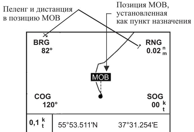
Дисплей плоттера в случае установки МОВ, как пункта назначения
