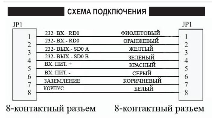
*Схема подключения при помощи 8-контактного разъема DSUB*
