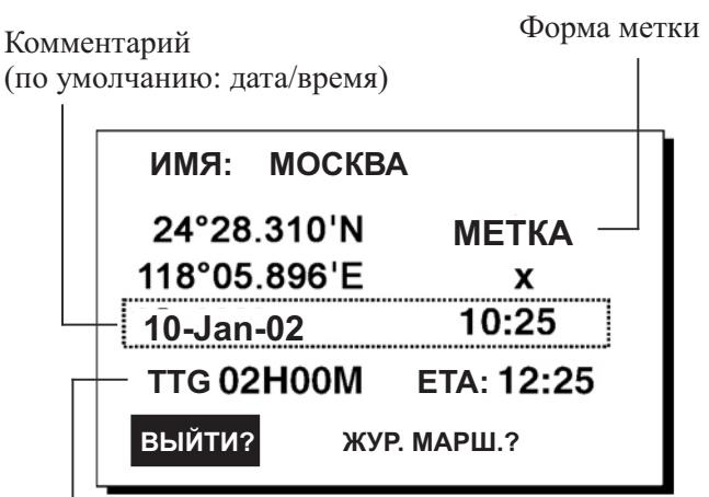
TTG (Длительность перехода) и ETA (Расчетное время прибытия), рассчитанные в соответствии с установленным в меню ПЛОТТЕР значением TTG/ETA СКОРОСТЬ.
